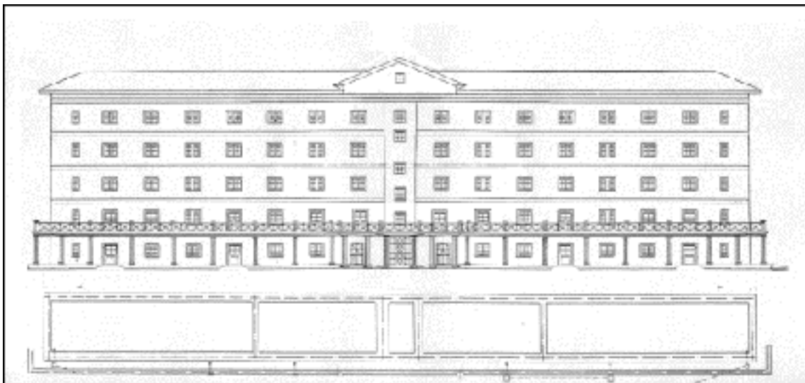
Fig.3 – Fachada principal del edificio “A” de acuerdo a uno de los proyectos en el que se suponía una cubierta sencilla una terraza en la planta primera del edificio, siguiendo la línea exterior de la acera perimetral original.
